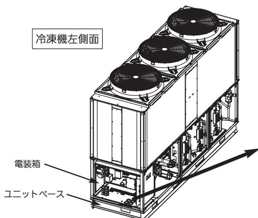
電装箱内下部に張付けてある樹脂クランパーで電源線・アース線・通信線等を束ね、電装箱配線取入口にある配線結束用ワイヤーを使用して、たるみがないように配線してください。
