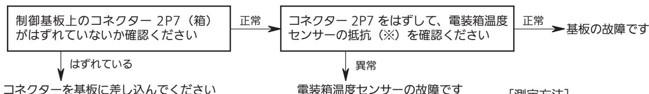
※ 電装箱温度が  $20^{\circ}\text{C} \sim 60^{\circ}\text{C}$  のとき、センサー抵抗値が  $14\text{k}\Omega \sim 70\text{k}\Omega$  なら正常です。
