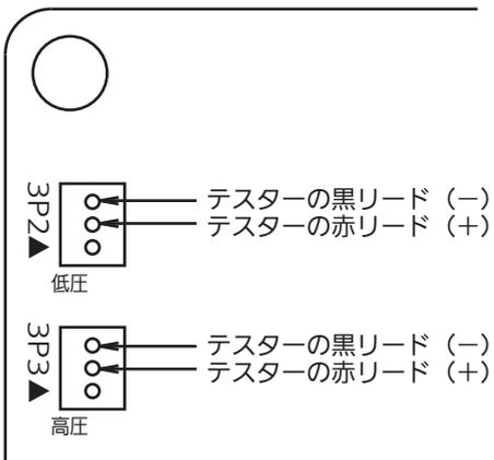
**注意** 圧力センサーの電圧確認は、必ずテスターの DCV レンジで行ってください。抵抗レンジではセンサー故障に至りますのでご注意ください。
