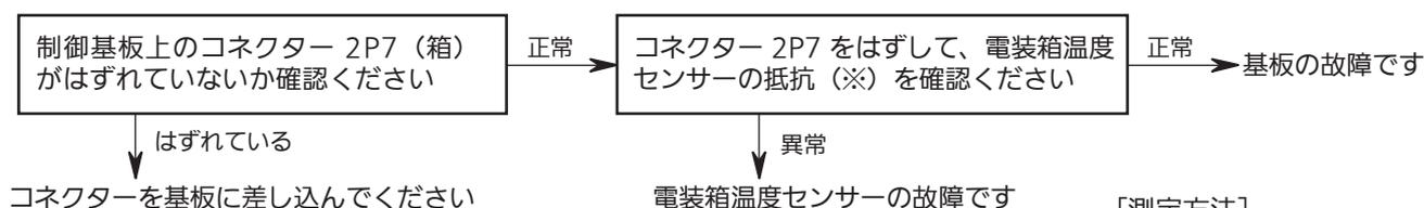
※ 電装箱温度が  $20^{\circ}\text{C} \sim 60^{\circ}\text{C}$  のとき、センサー抵抗値が  $14\text{k}\Omega \sim 70\text{k}\Omega$  なら正常です。
