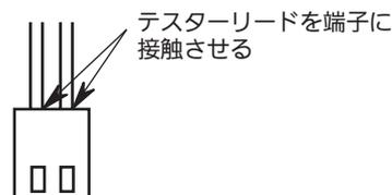
(5) 放熱器温度センサー：デジタル表示部に「E22」が表示される時。
