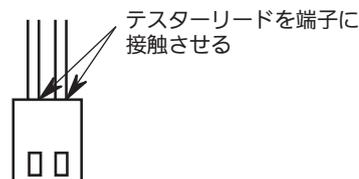
(6) 電装箱温度センサー：デジタル表示部に「E25」が表示される時。
