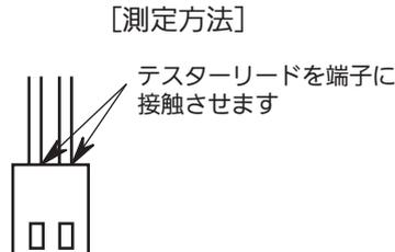
(2) 低圧圧力センサー：デジタル表示部に「E05」が表示されて、コンプレッサーが運転しないとき。
