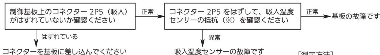
※ 吸入温度が  $-30^{\circ}\text{C} \sim 20^{\circ}\text{C}$  のとき、センサー抵抗値が約  $2\text{k}\Omega \sim 25\text{k}\Omega$  なら正常です。
