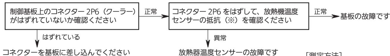
※ 放熱器温度が  $20^{\circ}\text{C} \sim 100^{\circ}\text{C}$  のとき、センサー抵抗値が約  $3\text{k}\Omega \sim 100\text{k}\Omega$  なら正常です。
